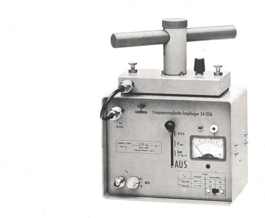
Der Frequenzvergleichsempfänger dient zur Verbesserung der Genauigkeit von quarzgesteuerten Frequenz - Messern, -Dekaden, -Zählern und ähnlichen Geräten durch Vergleich ihrer Steuerfrequenz mit der auf ca. 1 · 10<sup>-11</sup> konstantgehaltenen Trägerfrequenz des Langwellensenders 155 kHz (Deutschlandfunk).
